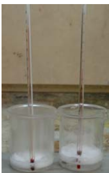
図4 Na 2 CO 3 と濃硫酸(左)とリン酸の反応
