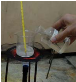
図3 NaClとリン酸の反応
