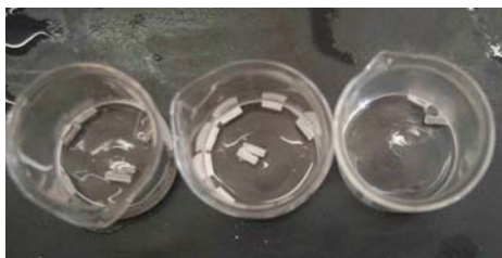
図6 Mgと硫酸の反応の粘性の影響 左から濃硫酸, グリセリンで粘性を持たせた希硫酸, 希硫酸の順
